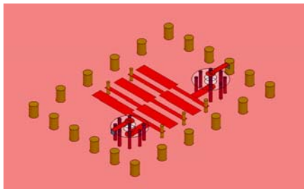
Fig.3 3D module of the band-pass filter in C band 图 3 C 波段带通滤波器的三维模型图
