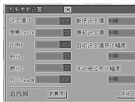
Fig.5 Control parameters setup of DCS OS 图5 操作员站上的控制参数设定
