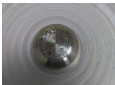
Fig.4 Erosion distribution on Rogowski electrode 图4 罗克夫斯基电极表面烧蚀情况图
