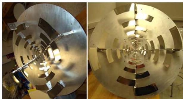
Fig.3 QSC feed(0.4~4GHz) developed at Cornell University 图 3 Cornell 大学研制的 0.4~4 GHz QSC 馈源 [10]
