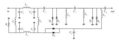
Fig.7 Schematic of semi-active limiter 图 7 半有源式限幅器电路原理图
