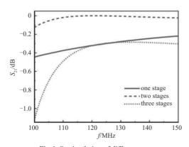
Fig.4  $S_{21}$  simulation of different stages 图 4 不同级数 $S_{21}$ 仿真结果
