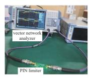
Fig.9 Measurement of S parameter 图 9 S 参数测试
