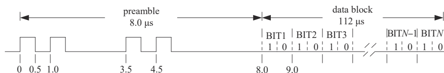
Fig.2 ADS-B 1 090 MHz ES pulse signal 图2 ADS-B_1 090 MHz_ES脉冲信号
