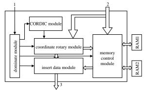
Fig. 2 Diagram for eliminating TV-display rotation 图 2 电视消像旋方案设计框图
