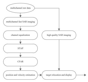
Fig.1 The flowchart of STAP-GMTI algorithm 图 1 多通道 GMTI 算法简略流程图
