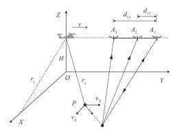
Fig.2 The imaging geometry for the SAR-GMTI system 图 2 三通道 GMTI 系统示意图
