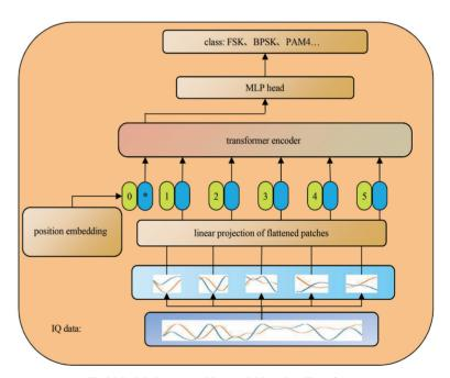
Fig.3 Modulation recognition model based on Transformer 图 3 基于 Transformer 的调制识别模型
