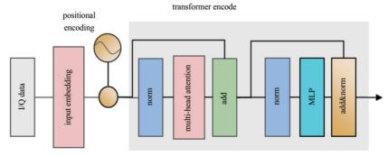
Fig.2 Structural diagram of Transformer model encoder 图 2 Transformer 模型编码器结构示意图
