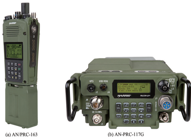
Fig.4 Typical radio products of Harris Corporation 图4 美国Harris公司典型电台产品
