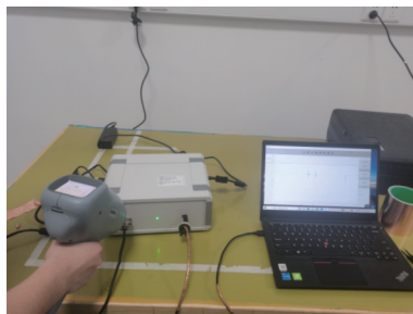
Fig.9 Diagram of ESD test site 图 9 ESD 测试现场图
