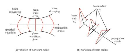
Fig.1 Schematic of Gaussian beam propagating 图 1 高斯波束传播示意图
