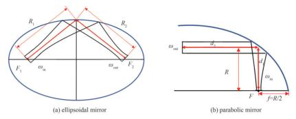
Fig.2 Schematic of Gaussian beam transformation 图 2 高斯波束变换图
