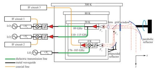
Fig.5 Layout of Dewar and quasi-optical system 图 5 杜瓦和光路布局
