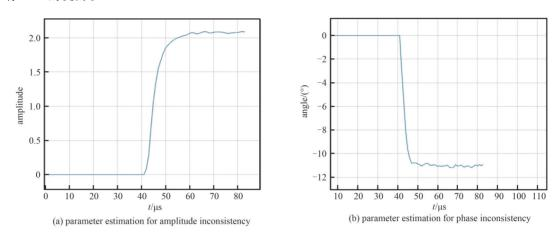
Fig. 10 Diagram of parameter estimation for amplitude and phase inconsistency 图 10 幅相不一致参数估计示意图
